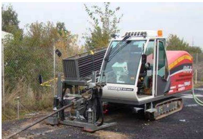
TERRA-JET 4015 S во время пилотного бурения
